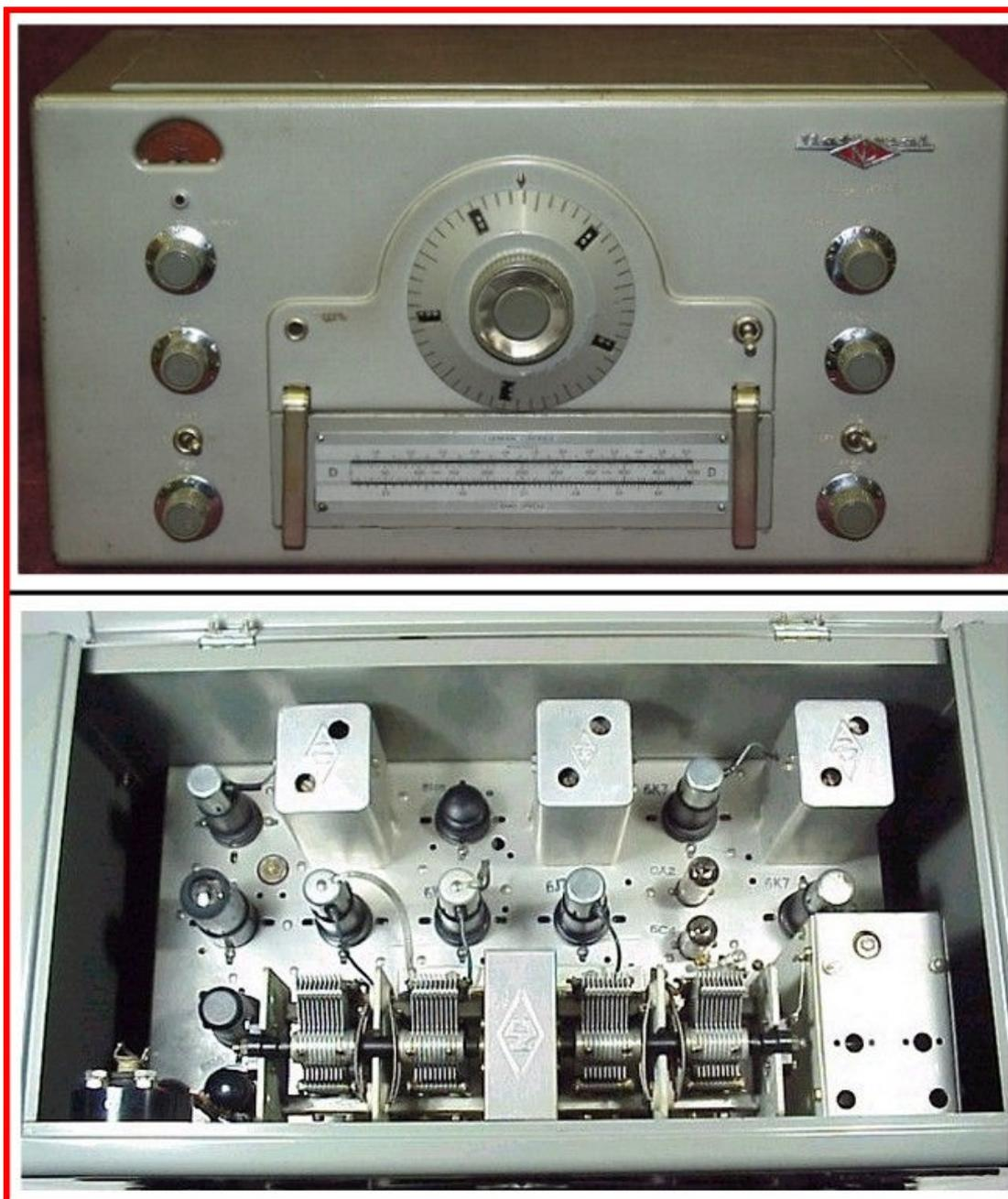
Fig.13 - HRO\_7: modello successivo dell'HRO-5TA1, del quale conserva l'architettura circuitale. Notare l'inserzione della valvola stabilizzatrice OA2 e la 6C4 in sostituzione della 6J7.
